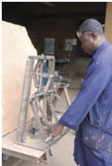
L'estampeuse, développée par le CIFOM au Locle, a été acheminée au Burkina Faso. L'atelier du CEAS-Burkina l'adaptée avec des matériaux locaux.
