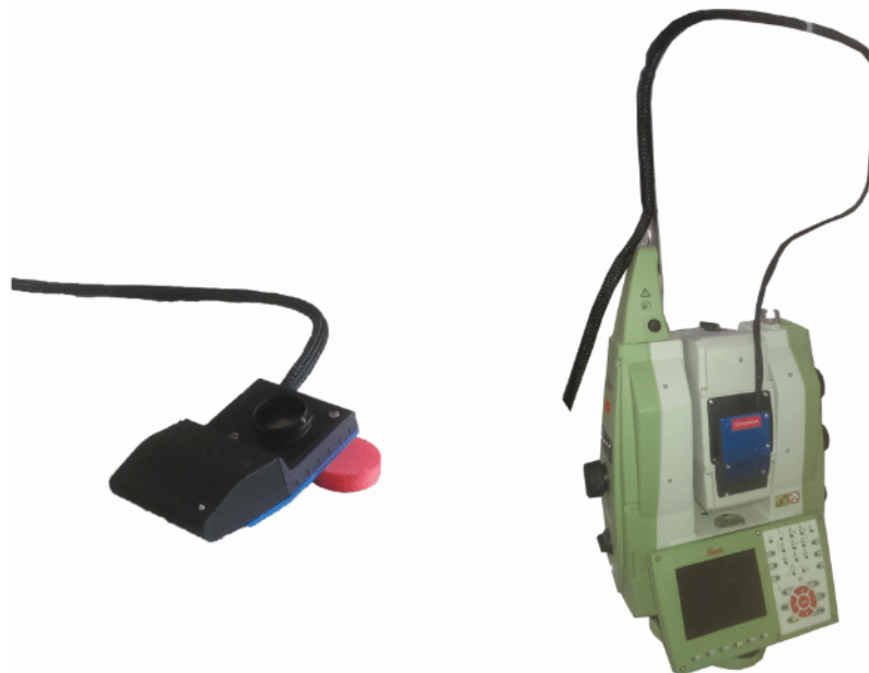
FIGURE 1.3 – Caméra CCD ; Système QDaedalus installé sur une station totale 2 .
