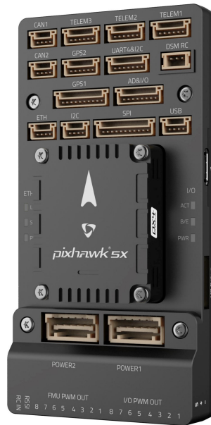
FIGURE 1.5 – Contrôleur de vol Pixhawk 5X 12 ;
