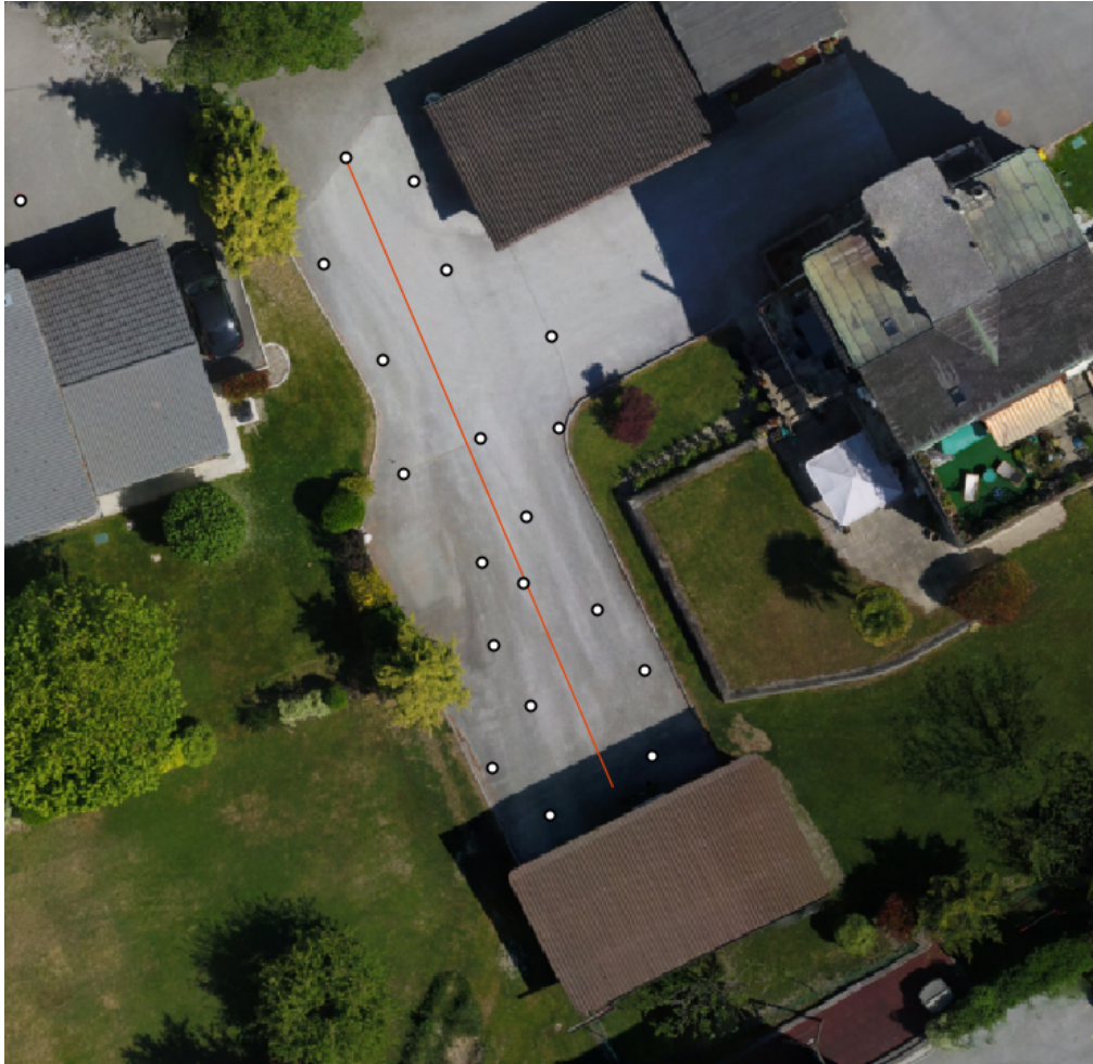
FIGURE 3.2 – Zone de test pour la qualification du guidage ; Points blancs : points de calage déterminés à la station totale ; Ligne rouge : plan de vol.
