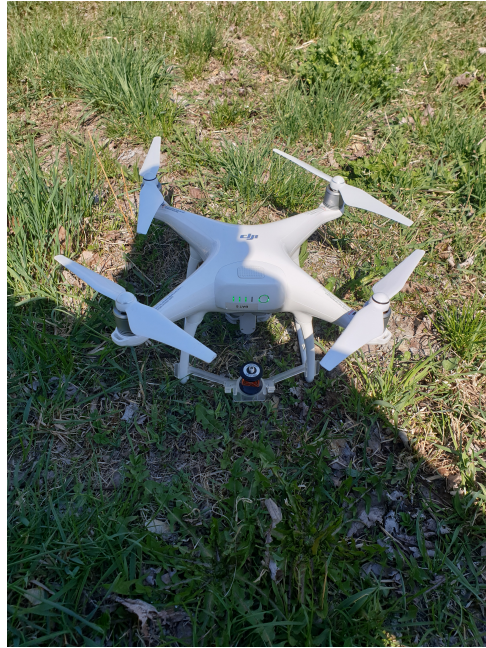
FIGURE 2.22 – Montage du mini primse 360° sur le DJI Phantom 4.
