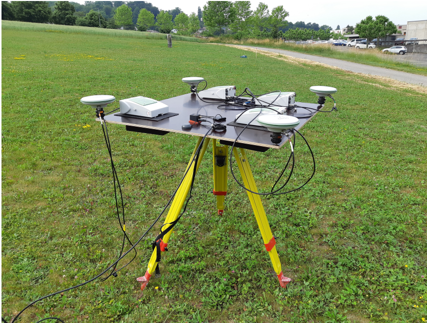
FIGURE 48 – Test avec la plateforme fixée sur un trépied et tournant sur elle-même
