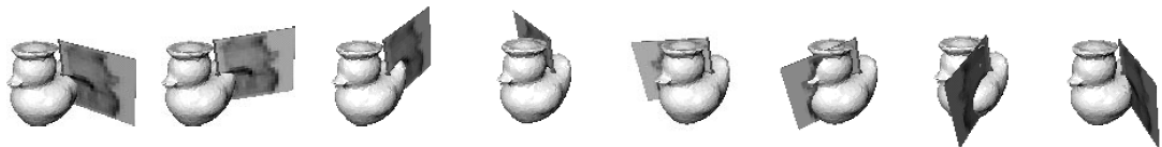
FIGURE 1.4 – Huit cadres d'animation qui motivent le nom spin-image. Le processus de génération de spin-image peut être visualisé comme une feuille tournant autour de la normale du point orientée, accumulant des points comme s'il balaye l'espace [Johnson, 1997].
