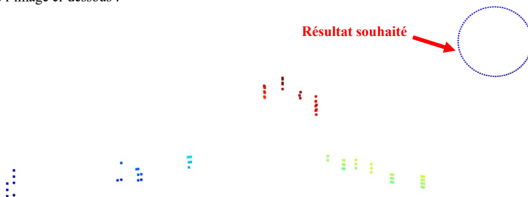
Image 78 - Problème dû aux grosses coordonnées lors de la génération des cercles dans le « Script cylindre »
