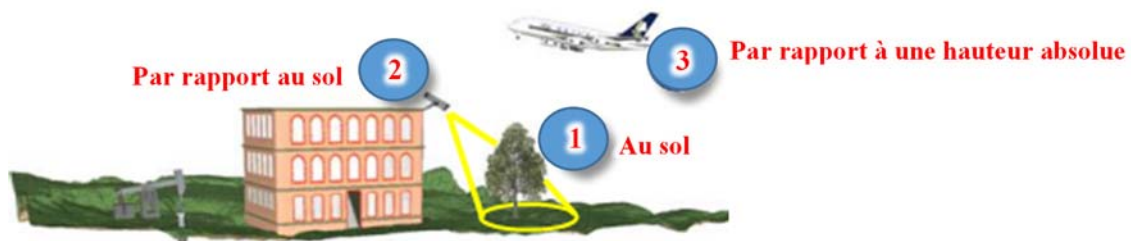
Schéma 9 - Illustration des paramètres d'altitudes d'ArcGIS Pro (Esri, 2022)
