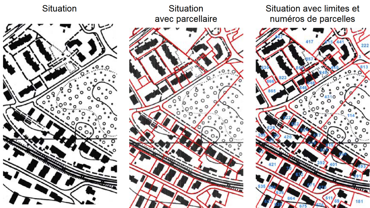
FIGURE 1.3 – Plan d'ensemble au 1 : 5000, source : OIG
