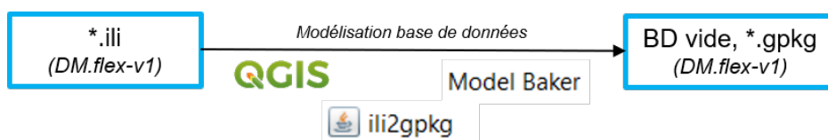
FIGURE 3.3 – Traitement des modèles *.ili DM.flex-v1.0 vers la BD GeoPackage
