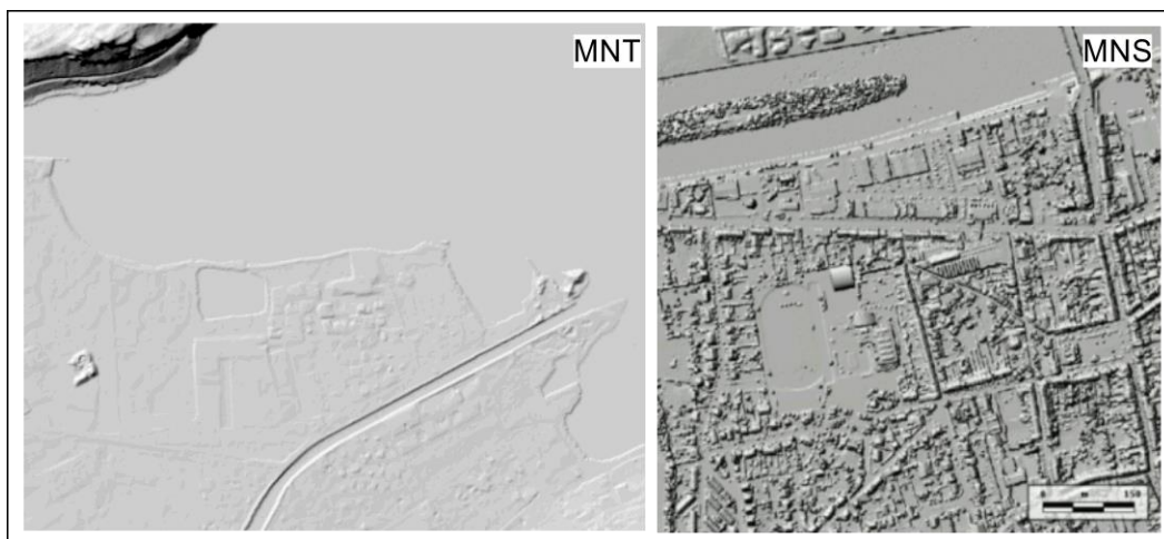
Figure 9 : Illustration de la différence entre le modèle numérique de terrain (MNT) et de surface (MNS). L'image du MNS est tirée du géoportail de la Wallonie (Direction de la Gestion hydrologique intégrée 2004).
