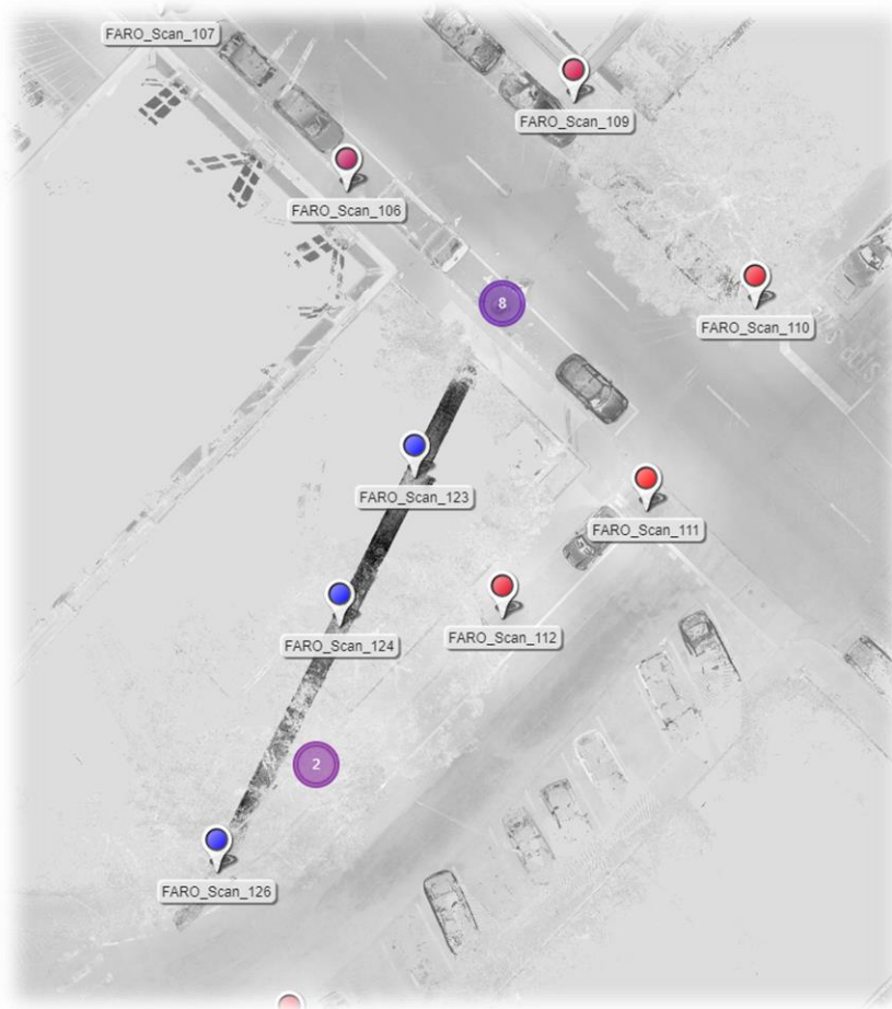
FIGURE 8 - RÉSULTAT DU SCAN EFFECTUÉ PAR LE GROUPE GAVA DANS LE LOGICIEL SCENE 2GO
