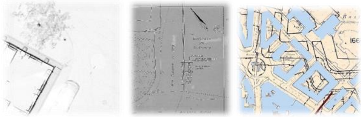
FIGURE 11 - POINTS DE REPÉRAGE DES DIFFÉRENTS RELEVÉS POUR AJOUTER LES POINTS DE CONTRÔLE
