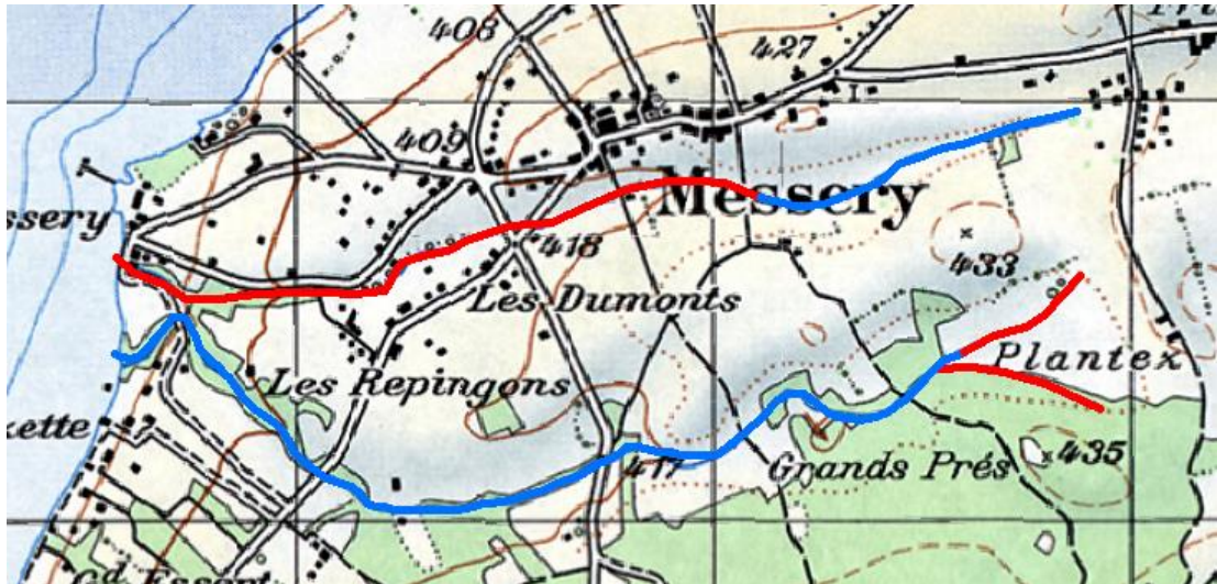
Figure 15 : Digitalisation des tronçons d'eau disparues (en rouge), en superposition avec le cours d'eau existant (en bleu) et la carte historique géoréférencée.
