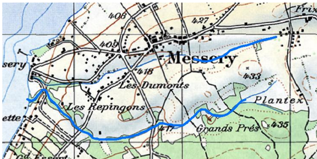
Figure 14 : Superposition de la couche IGN de tronçon cours d'eau (en bleu) et la carte historique géoréférencée.
