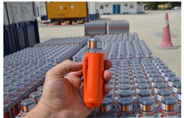
Figure 18: Géophone de Stryde, petit, compact et léger.
