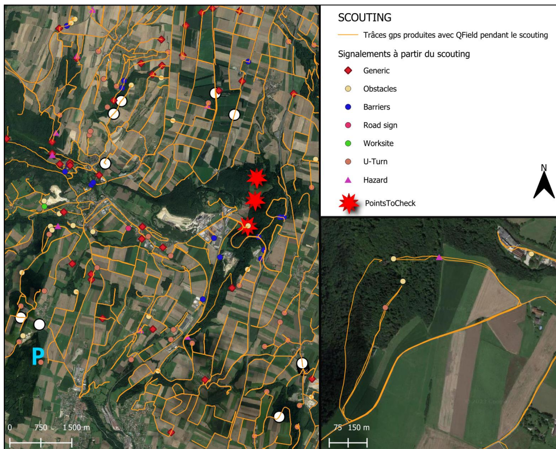
Figure 22: Exemple du résultat obtenu après plusieurs journées de repérage avec la trace GPS et les modifications et commentaires apportés grâce à QField, visualisé dans QGIS.
