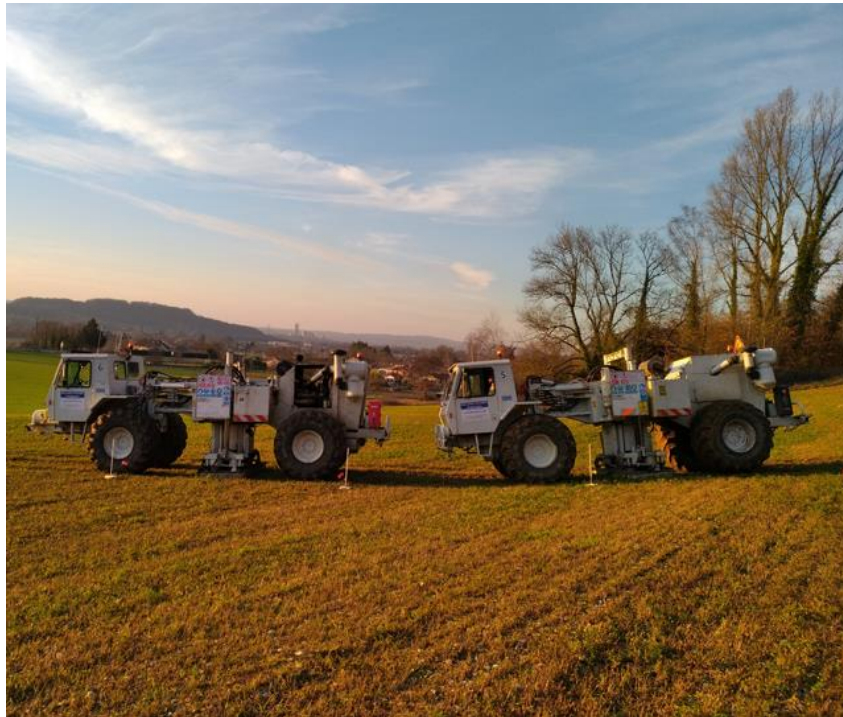
Figure 7: Camions-vibrateurs mobilisés pour la campagne de sismique 2D à Genève. Image de http://vibro seismic.com/tour.html .
