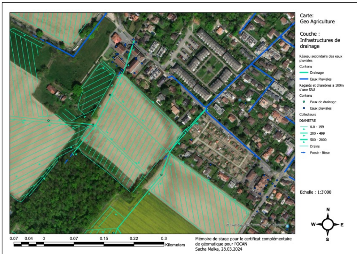
Figure 28. Carte Géo-Agriculture, couches des infrastructures de drainage
