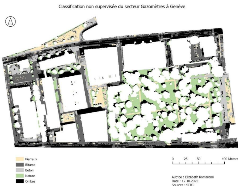
Figure 6 : classification non supervisée ISO5 du secteur Gazomètres à 40cm du sol avec ombres
