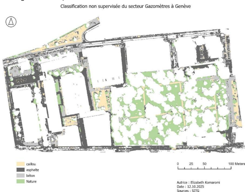
Figure 7 : classification non supervisée ISO5 du secteur Gazomètres à 45cm du sol sans ombres
