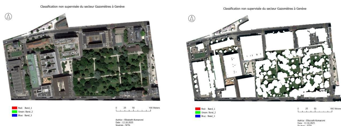
Figure 4 : filtrage altimétrique des objets en hauteur grâce au Modèle Numérique de Hauteur
