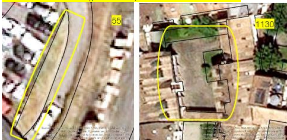
Figure 25 : incohérences géométriques entre OpenStreetMap et la couverture du sol
