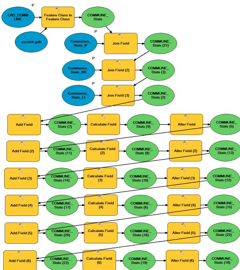
Figure 11: Diagramme Model Builder de l'assemblage des trois couches de communes comportant les statistiques calculées pour les trois types de données (IF = flore vasculaire, BR = bryophytes, LI = lichens), et calcul des champs additionnant les statistiques des trois types.
