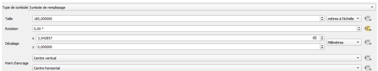
Figure 23 – Réglage de la taille et de l'espacement de la symbologie sur QGIS
