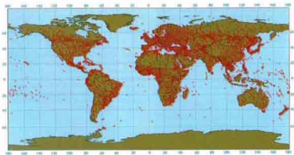
Le réseau synoptique de base régional de stations météorologiques en surface. Le Système mondial d'observations de la Veille météorologique mondiale de l'OMM comprend environ 10 000 stations au sol dont 900 effectuent aussi des observations en altitude, ainsi que 7000 navires et 600 bouées dérivantes.
